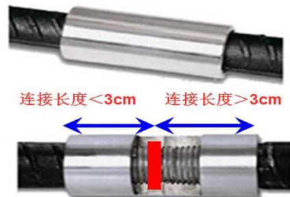
现场机械连接剖面示意图
