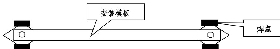
图13 安装模板与钢结构焊接示意图
